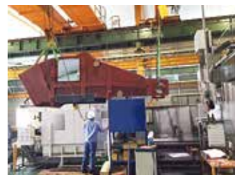
研磨加工 (CNC立形研削盤)
