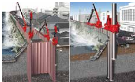
鋼矢板二重締切（左）、鋼管杭連続壁（右）
