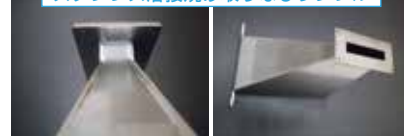
ステンレス溶接焼け取りなしサンプル
