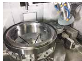
研磨加工 (CNC立形研削盤)
