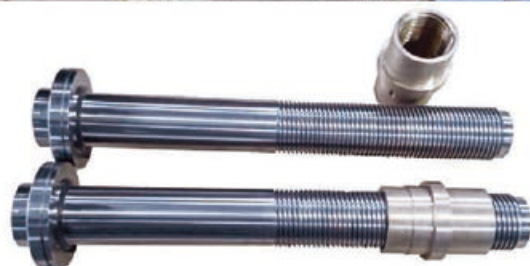
S45C (H) φ220×1030 (120台形2条ネジ“PIOリード”20) LBC4 φ165×210 (120台形2条ネジ“PIOリード”20)
