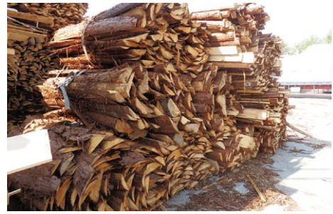
全面が剥げていない状態
